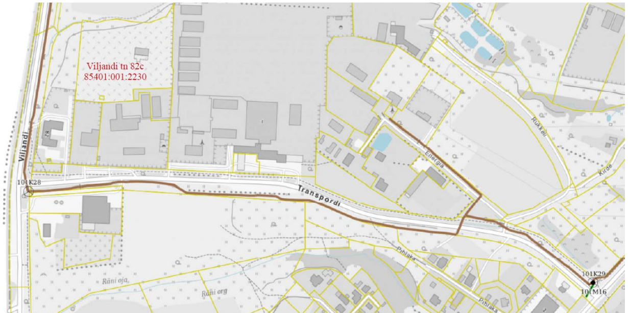
Skeem 7. Eesti Lairiba Sihtasutuse sidevõrk (Allikas: Eesti Lairiba Sihtasutuse tehnilistest tingimustest nr TT990VA)
